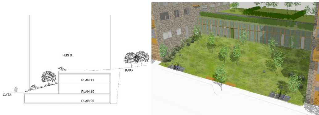
Figur 2: Sektion och illustration på indragen garagebyggnad mellan två av de tillkommande flerbostadshusen. Källa: HMXW Arkitekter
